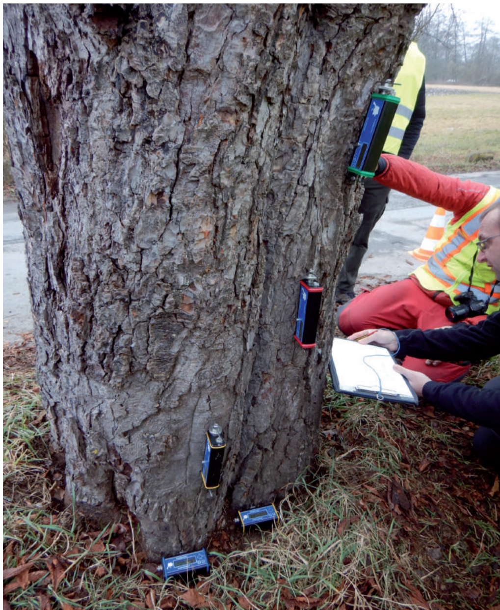
Albero di Ippocastano sottoposto a prova di trazione
